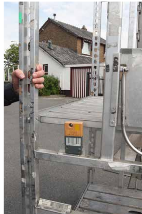
De slotplaat is een rechthoekig plaatje met een barcode en een tag erop.
