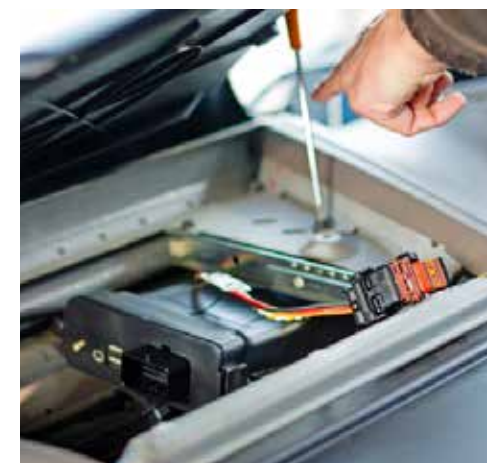
Bij 378 vrachtauto's is elektronica ingebouwd om het rijgedrag van de chauffeur vast te leggen.
